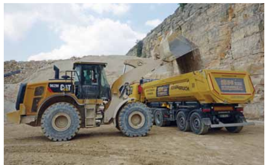
Viereinhalb Ladespiele erfolgen auf der untersten Sohle – das komplett zulässige Ladevolumen wird dann vor der Verwiegung ausgeschöpft.
