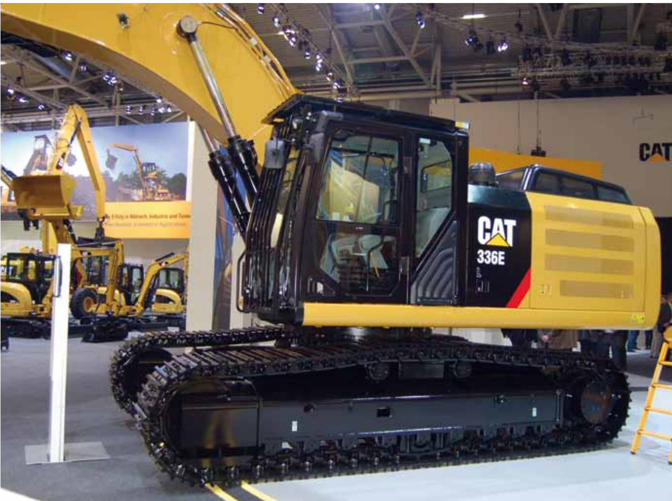
Der Prototyp des 36 Tonnen schweren Cat 336E wurde zur bauma 2010 präsentiert und gilt damit als erste Baumaschine, die schon zu jener Zeit über ein Peripheriesystem zur Abgasreinigung verfügte. Foto: Cohrs
