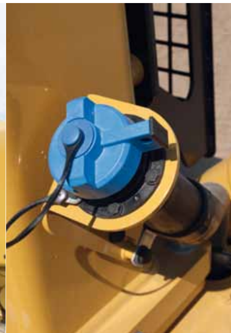
Nachfüllen für den Umweltschutz: Wirksam lassen sich Stickoxide im Abgas durch DEF (Diesel Exhaust Fluid) reduzieren, ein Gemisch aus Harnstoff und Wasser. DEF ist als AdBlue bekannt.
