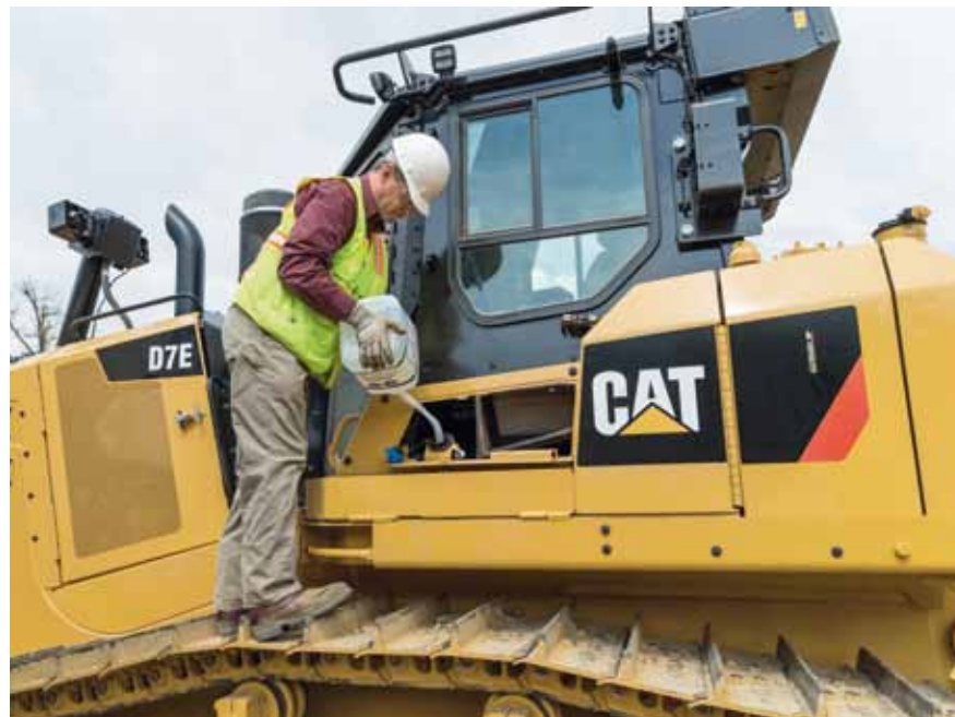
Nachfüllen für den Umweltschutz: Wirksam lassen sich Stickoxide im Abgas durch DEF (Diesel Exhaust Fluid) reduzieren, ein Gemisch aus Harnstoff und Wasser. DEF ist als AdBlue bekannt.
