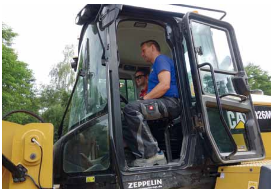
Einmalige Sonderkonstruktion: der Notsitz für Timo Raach (vorne), Baumaschinenmeister und Ausbilder für Baugeräte, der die Azubis von dort aus in den Umgang mit dem Radlader einweist.
