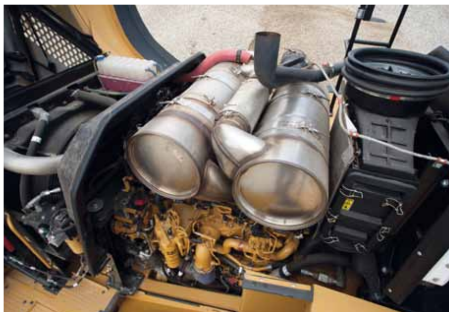
Nicht nur geringere Abgasemissionen sind wichtig, sondern auch funktionierende Baumaschinen. Deshalb richten die Ingenieure bei Caterpillar ihr Augenmerk sowohl auf robuste Abgassysteme als auch auf vorbildliche Wartungszugänglichkeit.
