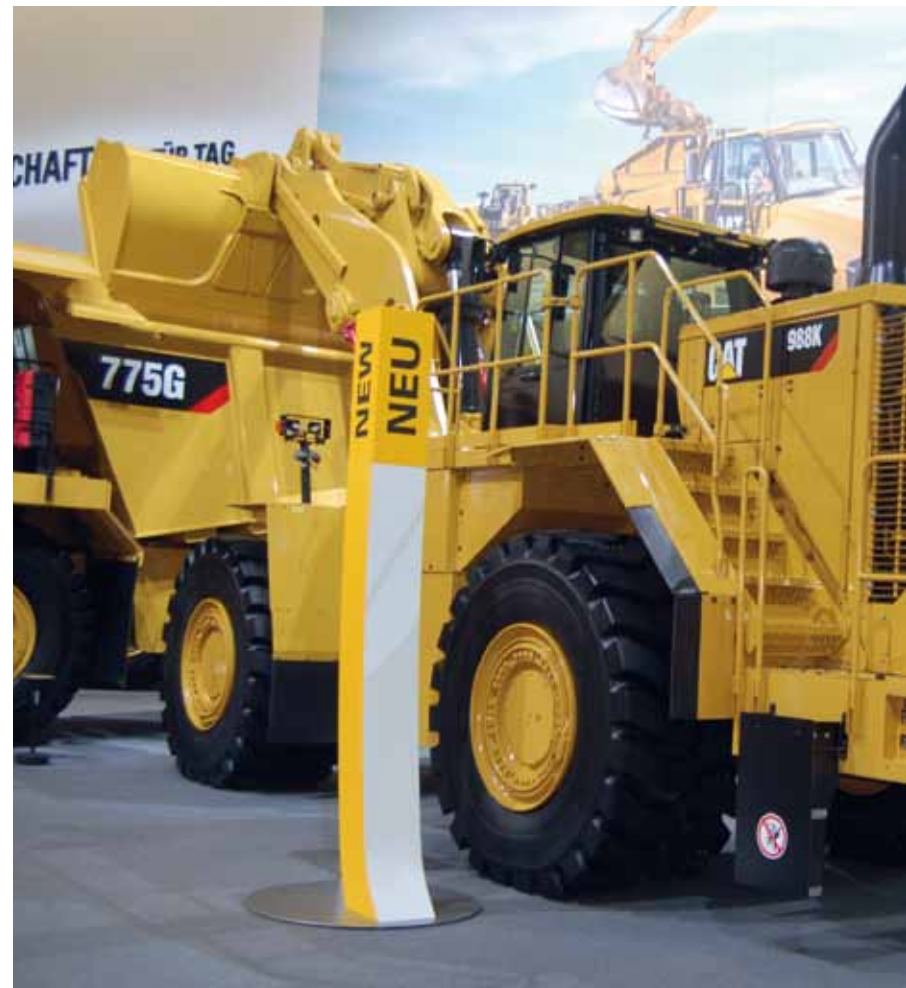
Weltweit eine der ersten Baumaschinen mit einem Motor gemäß EU-Stufe IV, auswar auf der bauma 2013 der 51 Tonnen schwere Radlader Cat 988K mit 7,6 Kubik
