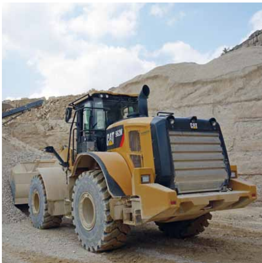
Am Ende des Förderbands nimmt der neue Radlader mit seiner 3,8-Kubikmeter-Schaufel das Material wieder auf und beschickt Lkw.
