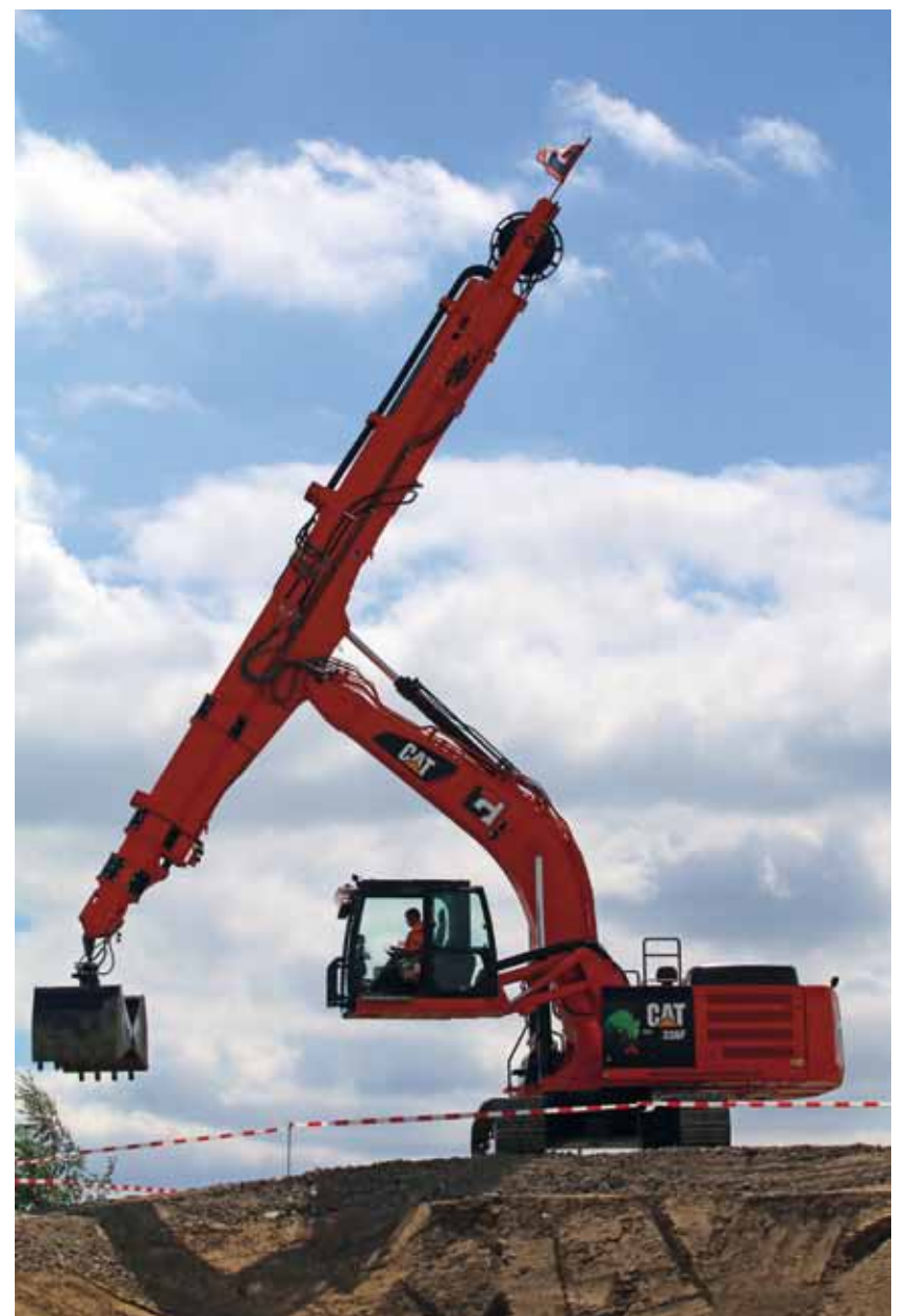
Der Teleskop wird hydraulisch mit Zylindern angetrieben und kann so einen punktuellen Druck auf das Erdreich ausüben.
